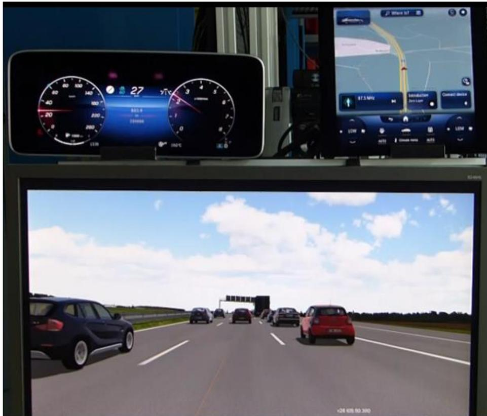
Abbildung 3: Staufahrt am HiL-Prüfstand
