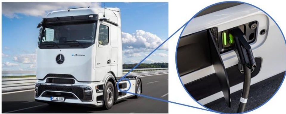
Abbildung 1: links: Mercedes Benz eActros 600 rechts: Detailansicht CCS-Ladedose mit Ladepistole Quelle: Daimler Truck
