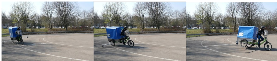
Abbildung 4: eLastendreiad mit Lenkwinkelsprung und zweifacher Kippneigung
